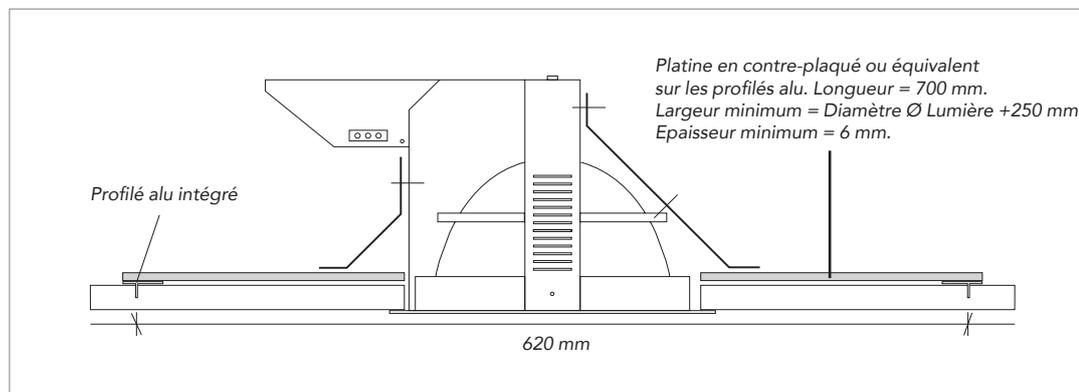
Cette solution est adaptée pour les luminaires (ou autres éléments) et les cadres dont la masse n'excède pas 5 kg. Faire une découpe dans l'îlot et centrer le cadre correspondant à la forme du luminaire.
