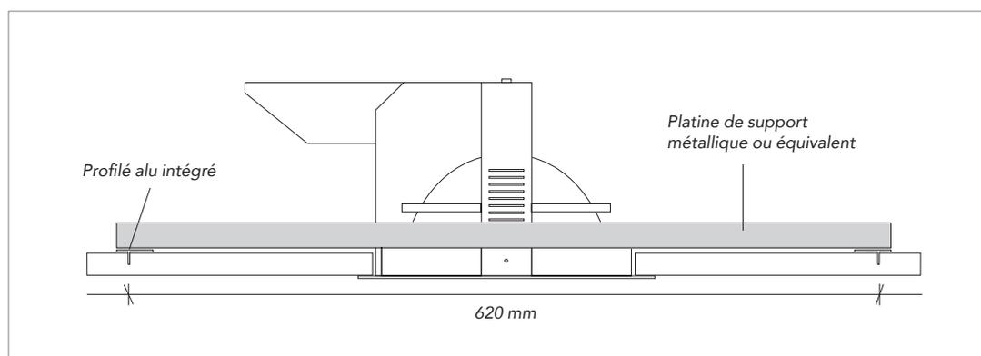
Cette solution est adaptée pour les luminaires (ou autres éléments) dont la masse n'excède pas 5 kg. Fixer le luminaire au moyen d'une ou plusieurs platines de support reposant sur les profilés alu. Faire une découpe dans l'îlot correspondant à la forme du luminaire.
