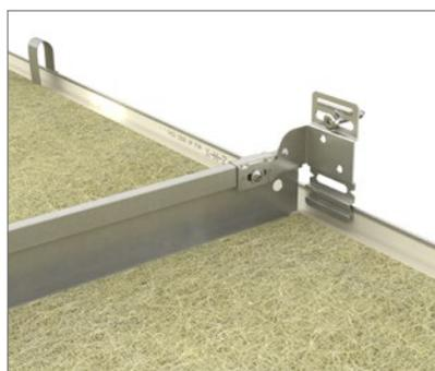
Afin de s'assurer de la perpendicularité du Rockfon System T24 X, il est recommandé d'utiliser une pièce de raccord pour murs et chevêtres sur chaque profilé porteur et toutes les deux entretoises.
