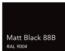
Brillance : 4.4 unités de brillant (UB) lors d'une mesure à un angle de 60° et 16 pour 85°
